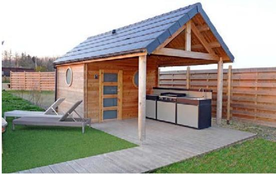
L'avancée se termine par des poteaux ronds surmontés d'une ferme, ce qui, avec les châssis ronds et la porte moderne vitrée lui confère un design très innovant. L'ouverture de la porte (80 x 180 cm) est vers l'intérieur. Pour une finition impeccable, il est équipé d'un revêtement de toiture en Akro-tuiles.
