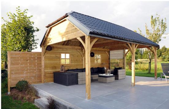
Superbe abri pour votre mobilier de jardin ou votre cuisine d'été, ce modèle est équipé de deux châssis fixes sur la cloison arrière et d'une persienne orientables. Il est équipé d'une ferme centrale, de planches de sous-toiture à profil Z et d'une couverture de toit en panneaux tuiles.
